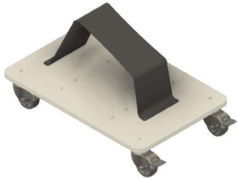
B) Befestigen Sie die beiden Halterungen mit den mitgelieferten 8x M5 Schrauben und den vormontierten M5 Muffen auf der Oberseite der Grundplatte.
